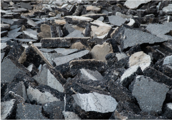
Reciclaje de asfalto
