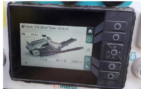
Automatización del control del proceso y encendido/apagado con un solo botón.
