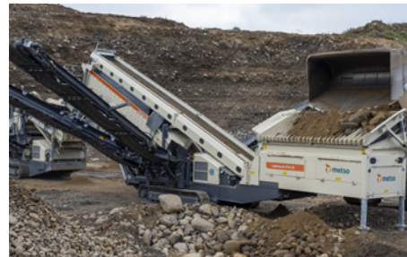
Grande caixa de alimentação que permite o processo de circuito fechado.
