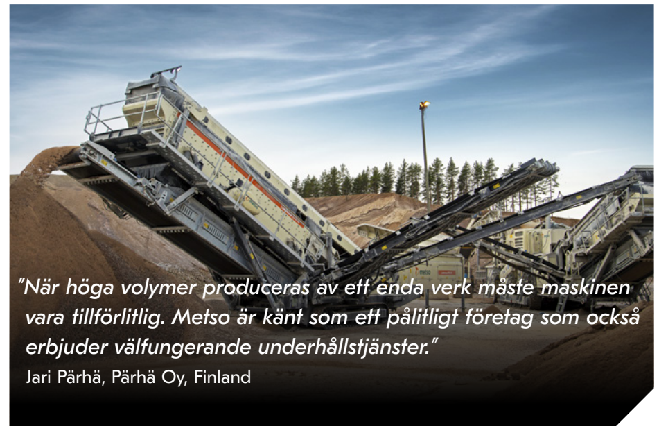
Stor pålastningsbox möjliggör sluten kretsprocess.
