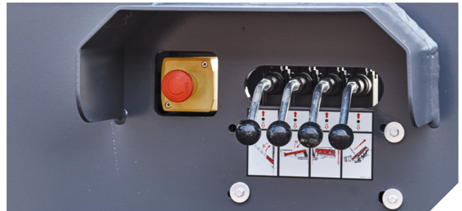
Seis paradas de emergencia, señal acústica de puesta en marcha, sistema de apagado del motor y protectores de puntos de atrapamiento para mayor seguridad
