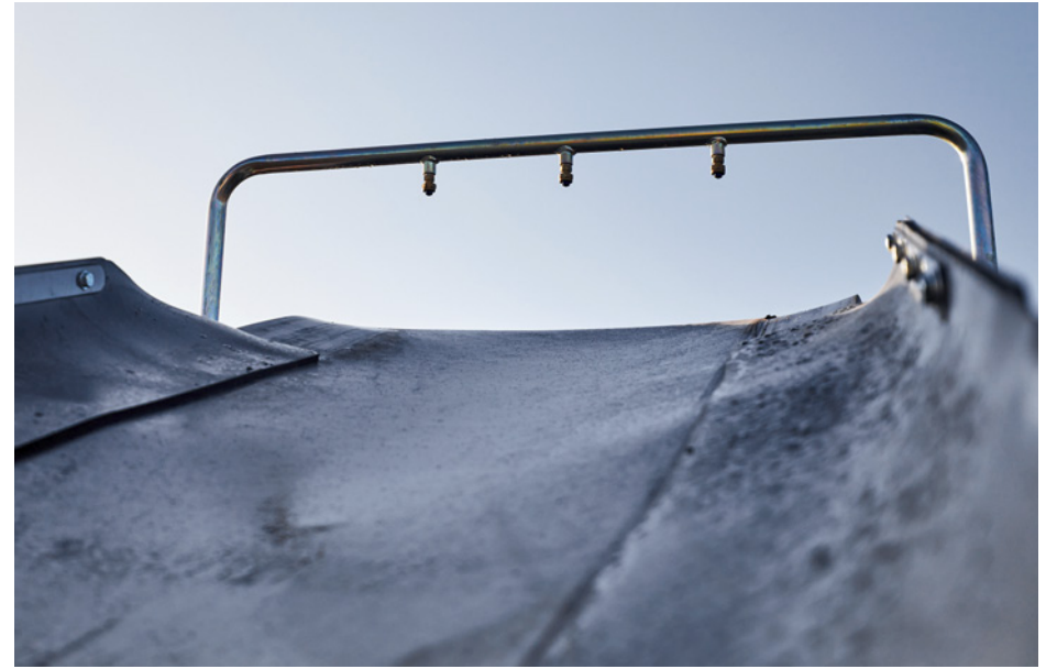
Sistema de difusión de agua con bomba de presión, para una supresión eficiente de polvo.
