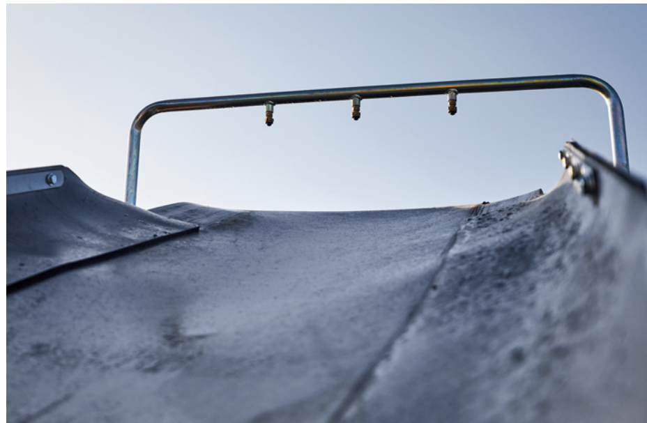
ポンプ付き散水システムで効率的な粉塵抑制。
