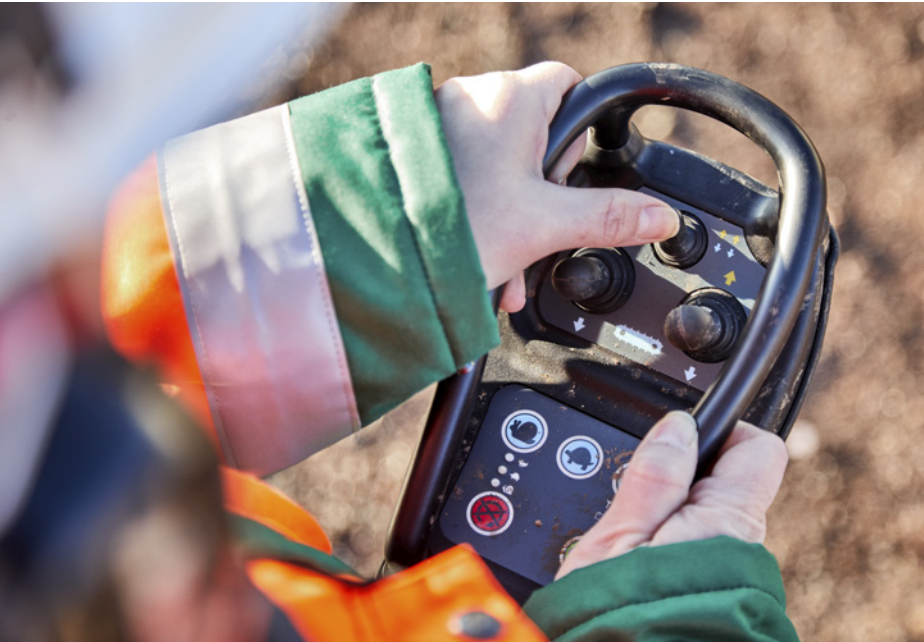
Standart olarak paletler için uzaktan kumanda.
