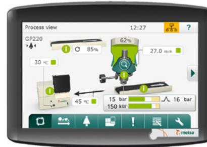
Optimización del chancado automático mediante el control de la velocidad de alimentación, en función del nivel de material y de las condiciones de carga de la chancadora
