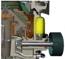
Sistema de desbloqueo con una gran carrera de limpieza para una limpieza rápida, segura y fácil de la cavidad en caso de que la chancadora se detenga bajo carga por cualquier motivo
