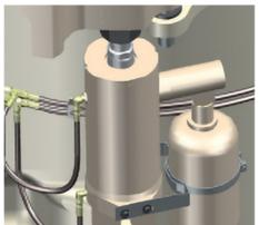
Réactivité et récupération immédiates en cas de surcharge grâce à des accumulateurs connectés aux vérins de passage des imbroyables
