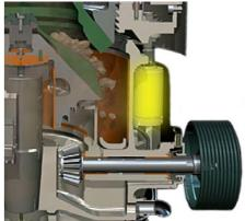
Système de passage des imbroyables avec grand espace de débourrage pour un débourrage rapide, simple et sûr de la chambre de concassage en cas d'arrêt du concasseur chargé, quelle qu'en soit la raison
