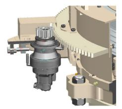
Motor hidráulico para ajuste da configuração e abertura do britador para o serviço e a troca de revestimento
