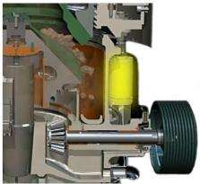
Sistema de desbloqueio com grande curso de limpeza para limpeza rápida, segura e fácil da cavidade caso o britador pare sob carga por qualquer motivo
